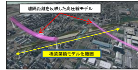
橋梁と架空線の離隔確認
