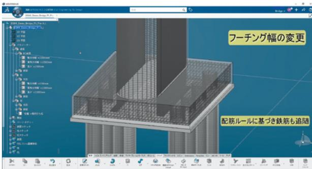
幅が広げられたフーチングに対して、自動的に配筋が追従し、再配筋がされた
