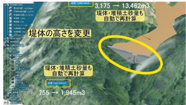
堤高を10mに変更すると堤体や堆積土砂量の堆積も自動的に再計算される
