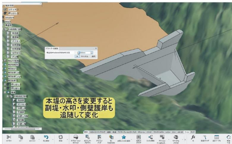
CATIAで作成したパラメトリックモデルによって砂防堰堤の比較検討を行った例。本堤の高さを変更すると副堤や水叩きの長さ、側壁護岸の大きさも自動的に変わる
