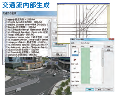
交通流内部生成 Traffic Generators (交通の生成) / Flow (交通流) 車種別割合、時間交通量設定による交通流生成と車の衝突制御が行える交通流シミュレーション
