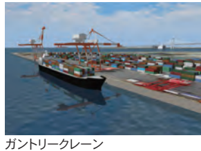
ガントリークレーン
