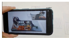
紙に印刷された形状マークにより、VRデータをサーバ経由で表示可能
