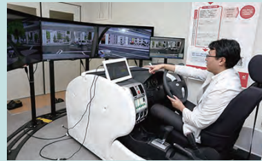
▲自動車の燃料消費モニタリングや運転車の挙動分析にドライバシミュレータを活用
