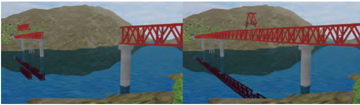
橋梁架設 (ステップシミュレーション)
