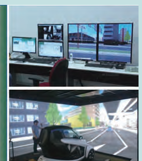
▲大型4K5面立体視ドライブシミュレータ 車両性能実証研究・開発用DSとして2015年にフォーラムエイトが名古屋大学へ納入
