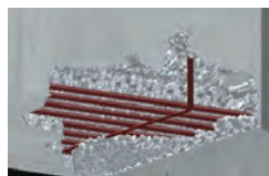
既設構造物を対象とした損傷箇所や補修状況の3D表現
