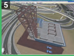
足場架設・ コンクリート打設・PC建込
